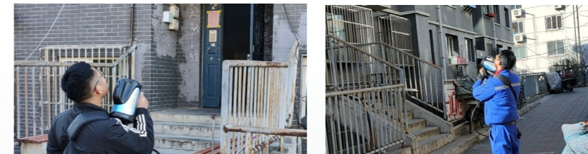
甲烷激光检测仪检测大排查
